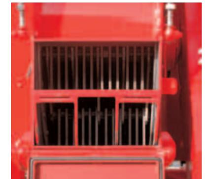
Die Mühlenklappe ist mit zwei Schraubverschlüssen gegen unsachgemässen Zugriff gesichert.
